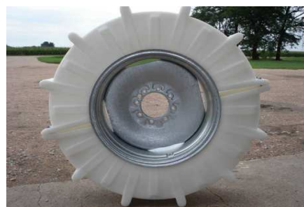
9. Rueda preparada para instalar en el pivot
