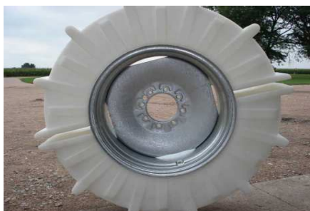
1. Las dos mitades apoyadas en la llanta
