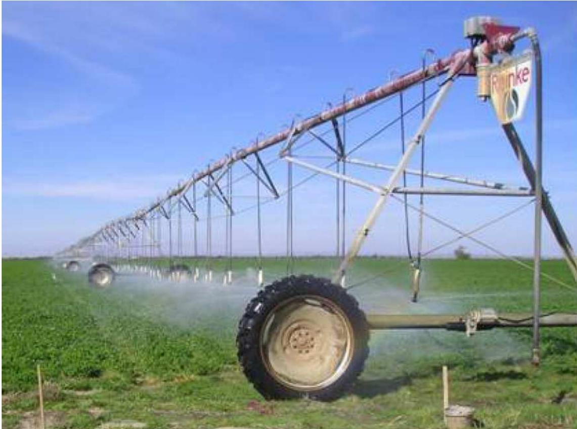
Se consultó al fabricante de los aspersores, Nelson Irrigation, para verificar que la altura de montaje de los aspersores era correcta. El pack original del Pivot 2 usaba Rotator R3000 con platos verdes. Este plato está preparado para funcionar con una presión de 20 a 50 PSI y a una altura de 6 a 9 pies.
