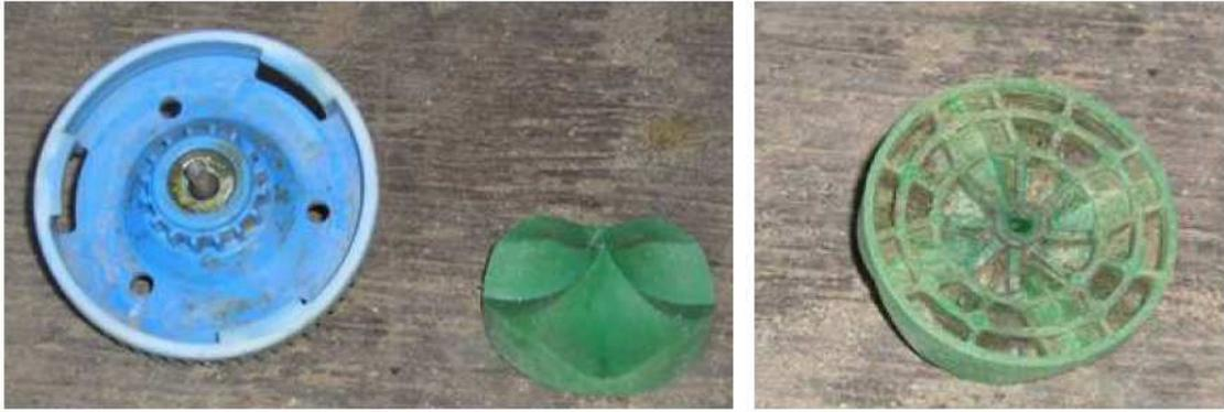
Casi todos los aspersores tenían algas o residuos entre el plato y el rotor, principalmente por un problema de filtración. Por lo tanto, la explotación redujo el intervalo de mantenimiento entre servicio y limpieza de aspersores y filtros.
