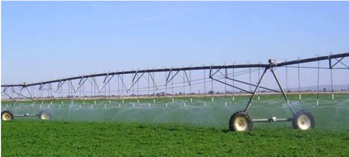
Los aspersores Rotator R3000 no se montaron tan altos como recomendaba el fabricante porque el Pivot operaba a 40 PSI y la dispersión por viento sigue siendo una preocupación, incluso ahora que se usan aguas residuales tratadas con cloro. Además, el mantenimiento del aspersor es más difícil colocándolo alto; esto se tratará en una sección posterior.
