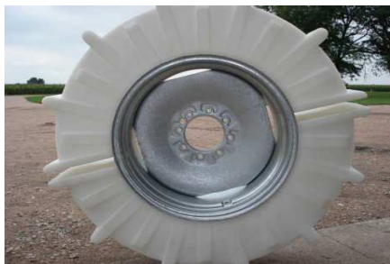
1. Las dos mitades apoyadas en la llanta
