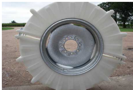
2. Las dos mitades con tornillos posicionados en su lugar
