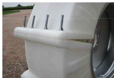
6. Completamente atornilladas con las partes de los tornillos sobrantes a la vista
