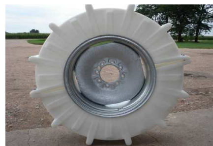
9. Rueda preparada para instalar en el pivot
